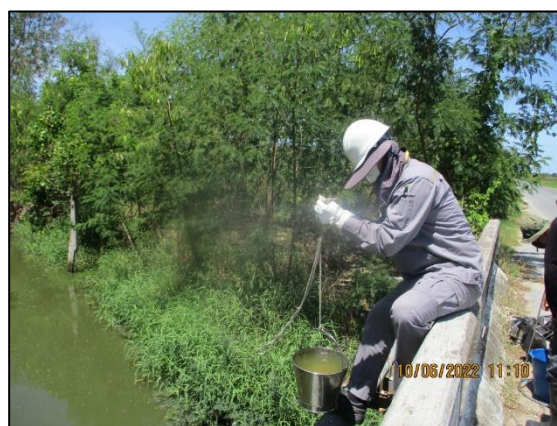
รูปที่ 3.18 การเก็บตัวอย่างแหล่งน้ำในพื้นที่โครงการและโดยรอบ บริเวณคลองบางนาง (SW6)
