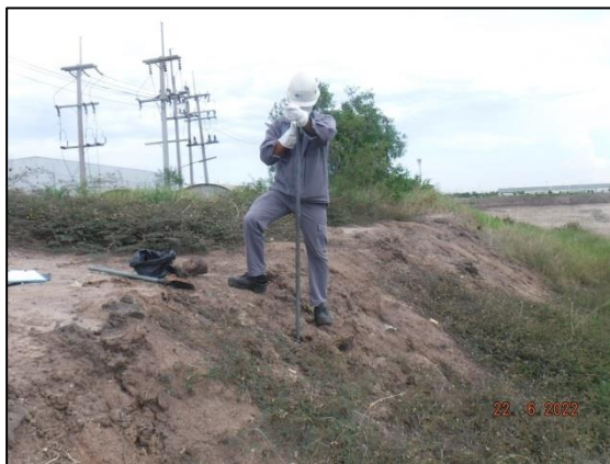
รูปที่ 3.11 การเก็บตัวอย่างวิเคราะห์ลักษณะสมบัติของดิน ที่ระดับความลึก 0-50 เซนติเมตร
