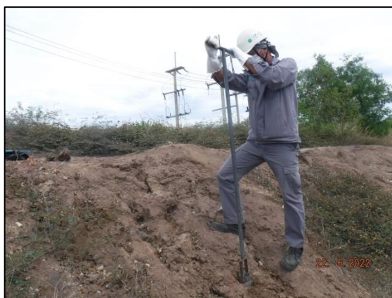
รูปที่ 3.12 การเก็บตัวอย่างวิเคราะห์ลักษณะสมบัติของดิน ที่ระดับความลึก 50-100 เซนติเมตร
