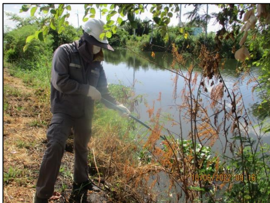
รูปที่ 3.13 การเก็บตัวอย่างตัวอย่างแหล่งน้ำในพื้นที่โครงการและโดยรอบ บริเวณ คลองพานทอง (SW1)
